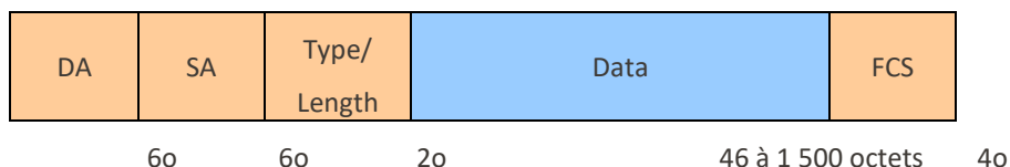
Figure 5 - Format trame Ethernet 2 et 802.3
